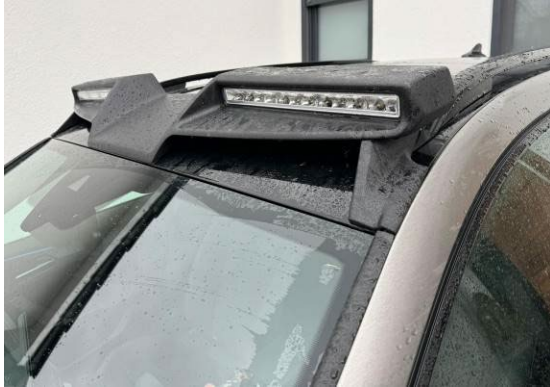
Bild 13: Dachblende mit LED Leuchten
